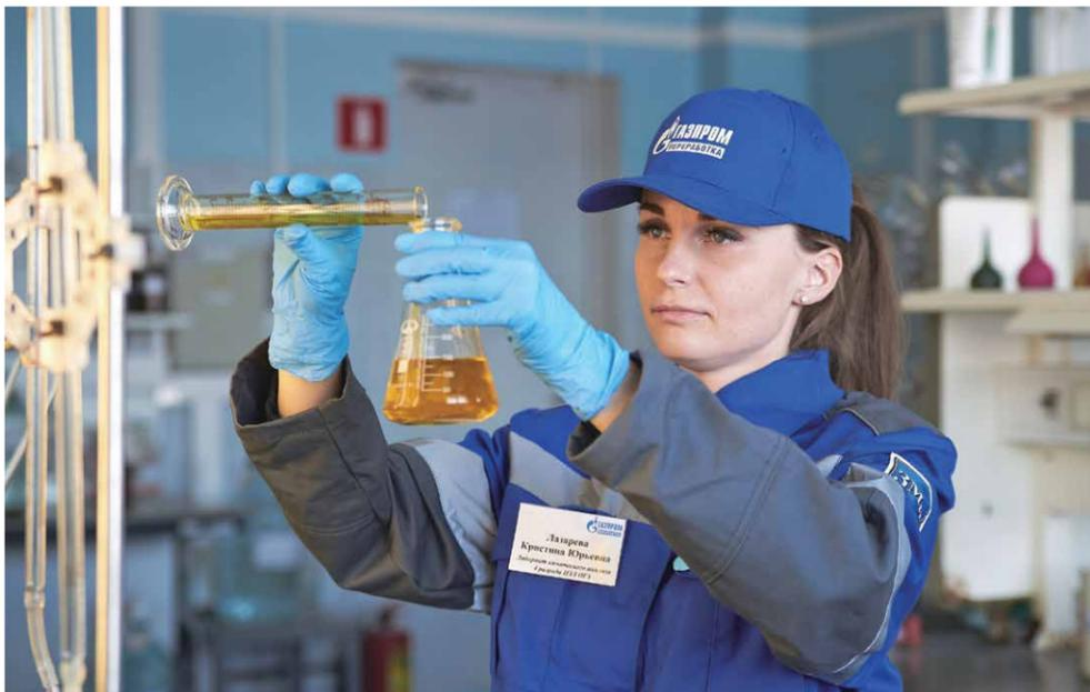
Лаборант химического анализа ОГЗ определяет массовую концентрацию хлоридов в пробе зашифрованного образца
