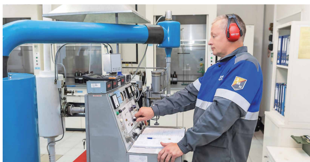
Определение цетанового числа дизельного топлива в центральной заводской лаборатории Сургутского ЗСК
